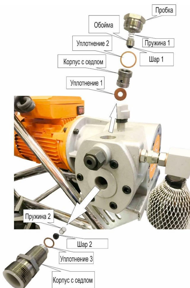
Рис.14 Схема расположения частей клапанов.
